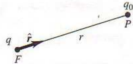
(a) El vector unitario \hat{r} apunta de la fuente puntual F al punto del campo P
