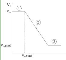
1.  $V_i < V_{BE}(on)$ : Q1 en **corte**, de modo que:
