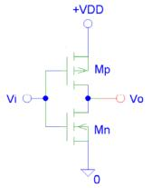
1.  $V_i < V_{thn}$ : Mn en **corte** y Mp en **zona lineal**:
