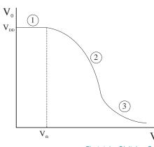
1.  $V_i < V_{th}$ : M1 en **corte**, de modo que:
