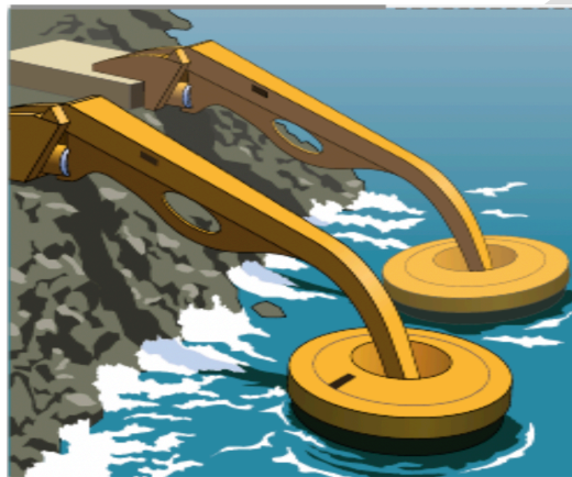
En Brasil se ha apostado por un modelo en el que las olas mueven unas boyas fijadas a unos brazos mecánicos.
